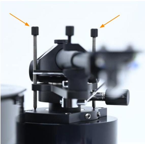
7.1 Для регулировки высоты тонарма в его комплектацию входят два регулировочных винта (устанавливаются, как показано оранжевыми стрелками на фото).
