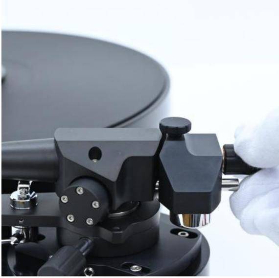
6.4 Вращением винта VTF отрегулируйте наклон тонарма и затем установите корректную высоту тонарма.
