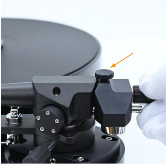
8.2 Теперь установите давление, рекомендуемое производителем звукоснимателя.
